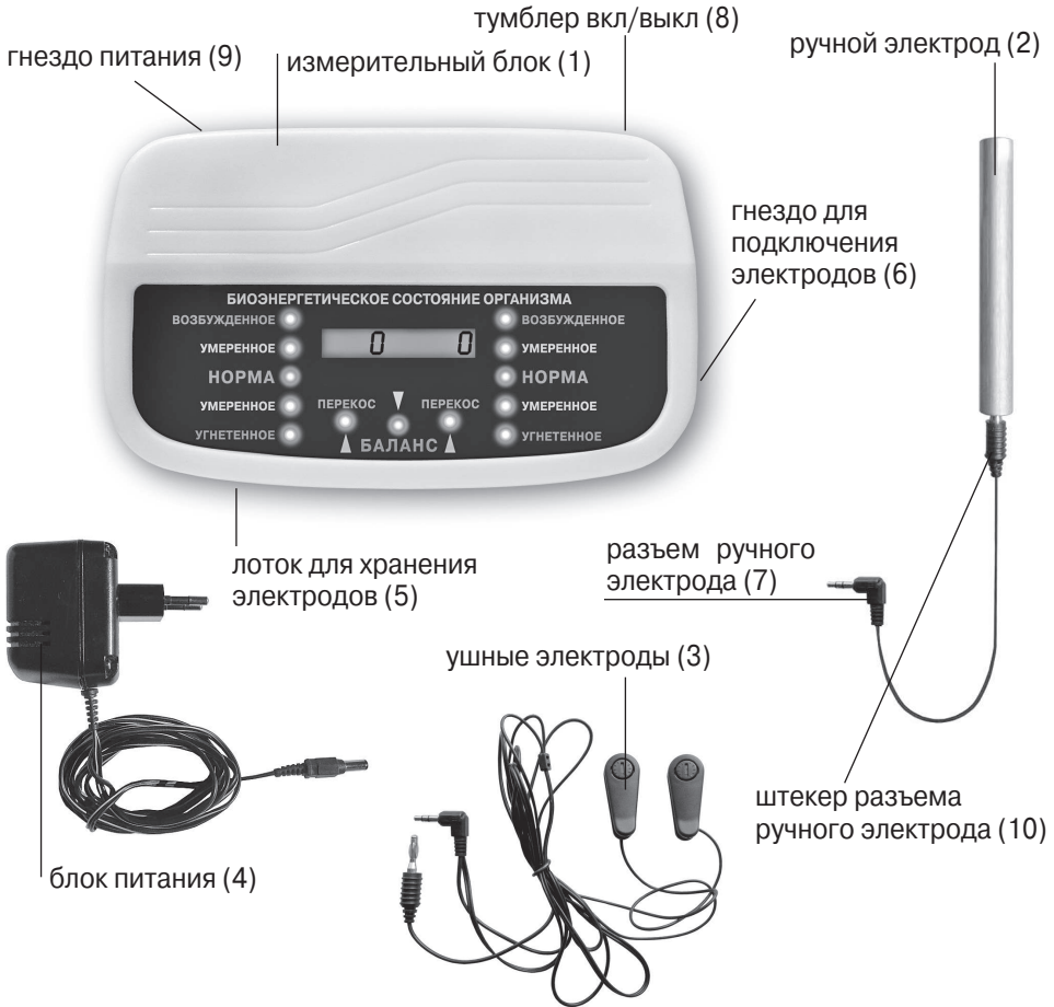
Рисунок 1. Схема аппарата «БИОКОРРЕКТОР».
